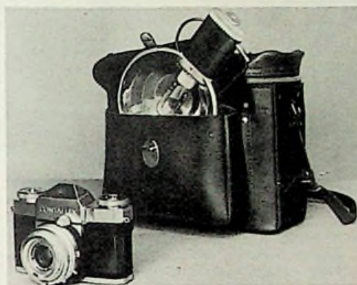
Bild 1. Elektronenblitzgerät EL 581, eingebaut in eine große Fototasche, die auch Raum für die eigentliche Kamera bietet
