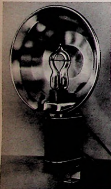
Links: Bild 3. Blitzlampe, gebaut unter Verwendung eines Agfa-Synchronblitzers für Vakublitz
